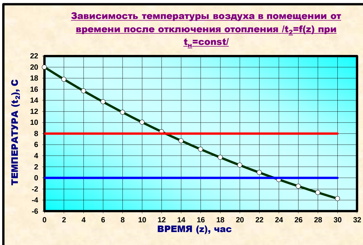
Рисунок 11.2.1 – Зависимость температуры воздуха в помещении от времени после отключения отопления при наружной t_{\text{наруж.}} = -10^0\text{C}
